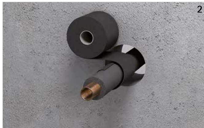
Rohrummantelung um die Dämmung legen (Lagenzahl beachten!) und Überlappung (ca. 20 mm) verkleben.
